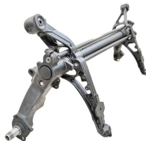
ZAMOCOWANIE DRAŻKA STABILIZUJĄCEGO W GNIAZDACH OBU WAHACZY
