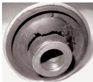
ZNISZCZENIE WARSTWY ELASTOMEROWEJ W POZIOMEJ TULEI WAHACZA
