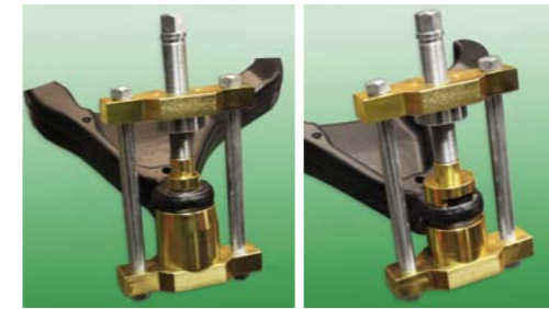
RYS. 11. UŻYCIĘ ADAPTERÓW I RĘCZNEJ PRASY DO WYCISKANIA (Z LEWEJ) I WCISKANIA (Z PRAWEJ) SWORZNI KULOWEGO
