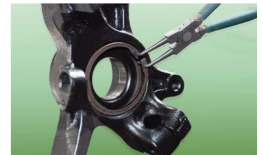
RYS. 16. WYJMOWANIE SPRĘŻYSTEGO PIERŚCIEŃNIA ZABEZPIECZAJĄCEGO WCISKOWO OSADZONE ŁOŻYSKO KOŁA
