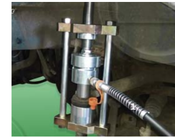
RYS. 12. PRASA HYDRAULICZNA DO DEMONTAŻU I MONTAŻU POŁĄCZEŃ WCISKOWYCH
