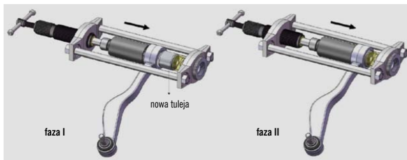
RYS. 9. KABŁĄKOWY WYCISKACZ SWORZNI Z GNIAZD CYLINDRYCZNYCH (1 - KABŁĄK, 2 - ŚRUBA DOCISKOWA, 3 - ADAPTERY)
