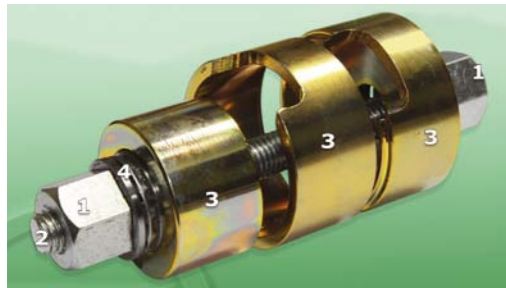
RYS. 8. PRZYRZĄD ŚRUBOWY DO DEMONTAŻU I MONTAŻU TULEI METALOWO-GUMOWYCH (1 - ŚRUBA, 2 - NAKRĘTKA, 3 - ADAPTERY, 4 - ŁOŻYSKO OPOROWE)
