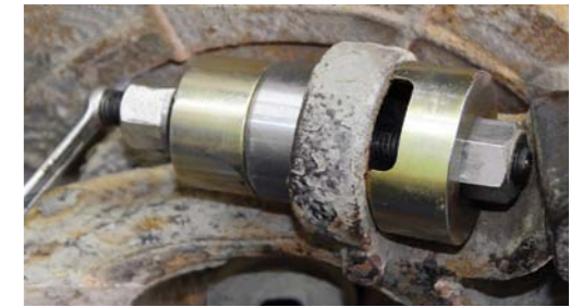
RYS. 13. ZASTOSOWANIE PRZYRZĄDU ŚRUBOWEGO I ADAPTERÓW DO MONTAŻU TULEI GUMOWEJ
