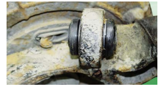
RYS. 14. PRAWIDŁOWE OSADZENIE TULEI GUMOWEJ W CYLINDRYCZNYM GNIEŹDZIE
