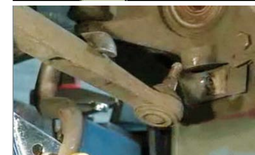
RYS. 6. UNIWERSALNY ŚCIĄGACZ DO STOŻKOWYCH POŁĄCZEŃ SWORZNI KULOWYCH I PRZYKŁAD JEGO UŻYCIA
