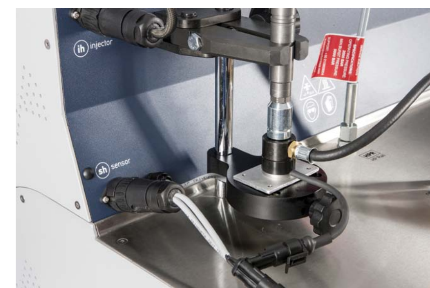
CZUJNIK RSP ZAMOCOWANY NA TESTOWANYM WTRYSKIWACZY CR
