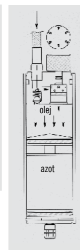
RYS. 1. SYSTEM SZPILKOWY Z DODATKOWYM ZAWOREM JEDNOKIERUNKOWYM, OGRANICZAJĄCYM REGULACJĘ WYŁĄCZNIE DO FAZY ROZCIĄGANIA. JEGO ZASTOSOWANIE W ODDZIELNYM ZBIORNIKU REGULUJE FAZĘ ŚCISKANIA
