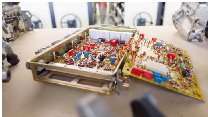
POCHODZĄCY Z 1967 ROKU STEROWNIK ELEKTRONICZNEGO WTRYSKU BENZYNY JETRONIC UTOROWAŁ DROGĘ DO ROZWOJU ELEKTRONIKI SAMOCHODOWEJ
