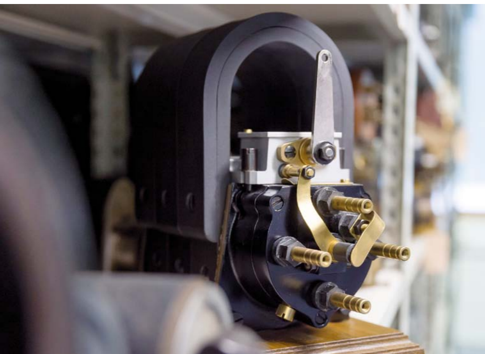
MAGNETO - PIERWSZY NA ŚWIECIE WYSOKONAPIĘCIOWY ISKROWNIK ZAPŁONOWY SKONSTRUOWANY W 1902 ROKU (Z LEWEJ) ORAZ WSPÓŁPRACUJĄCA Z NIM ŚWIECA ZAPŁONOWA
