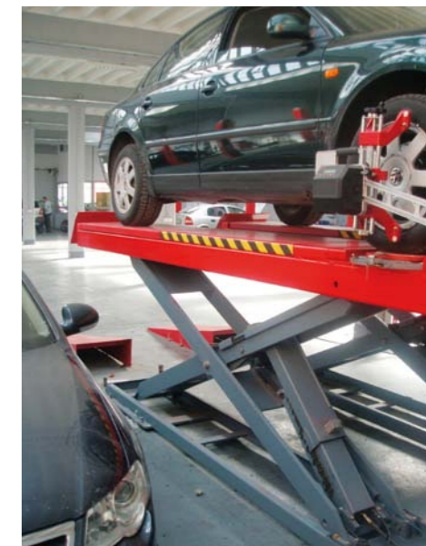
NOŻYCOWA KONSTRUKCJA NAJAZDOWEGO PODNOŚNIKA DIAGNOSTYCZNEGO
