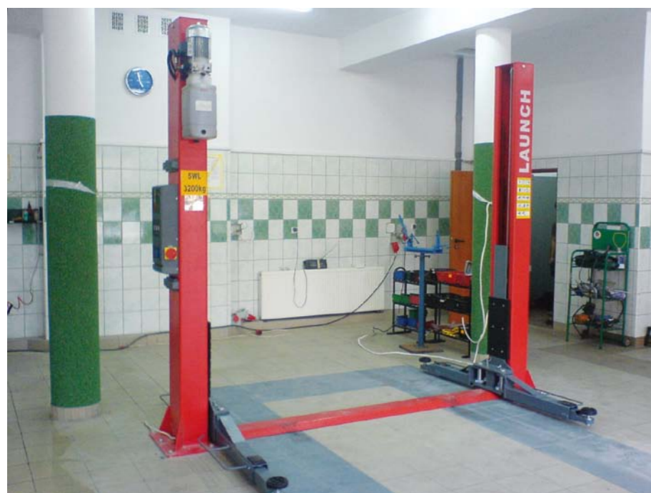
NAJBARDZIEJ UNIWERSALNĄ GRUPĄ PODNOŚNIKÓW SĄ KONSTRUKCJE DWUKOLUMNOWE
