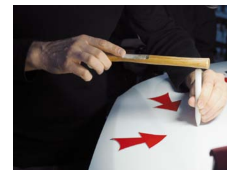
DELIKATNE WYGŁADZANIE LEKKIEJ WYPUKŁOŚCI POWSTAJĄCEJ W MIEJSCU WYPROSTOWANEGO WGNIECENIA
