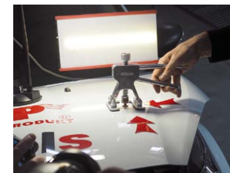
KLEJONYM ZACZEPEM PROSTUJE SIĘ WGNIECENIE DZIĘKI PEŁNIE DOZOWANEJ SIŁE DŹWIGNIOWEGO LUB ŚRUBOWEGO PULLERA ALBO UDAROM MŁOTKA BEZWŁADNOŚCIOWEGO
