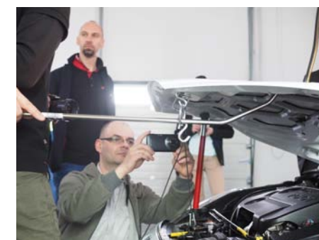
DŹWIGNIA WYPYCHAJĄCA WGNIECENIE MASKI (PODPARTEJ CZERWONYM WSPORNIKIEM) MA OŚ OBROTU NA HAKU ZACZEPIONYM O PROFIL WZMACNIAJĄCY
