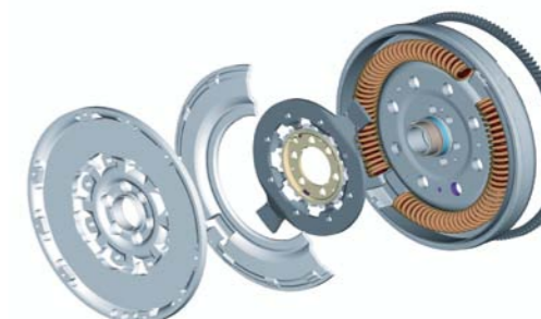
BUDOWA DWUMASOWEGO KOŁA ZAMACHOWEGO. OD PRAWIEJ: WIENIEC ZĘBATY, MASA PIERWOTNA, SPRĘŻYNY ŁUKOWE, ŁOŻYSKO ŚLIZGOWE, TARCZA ZABIERAKOWA, PIERŚCIEN KONTROLI TARCIA, POKRYWA, MASA WTÓRNA
