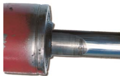
RYS. 13. W AMORTYZATORZE TAK ZUŻYTYM NALEŻY WYMIENIĆ TŁOCZYSKO I TULEJĘ PROWADNICY
