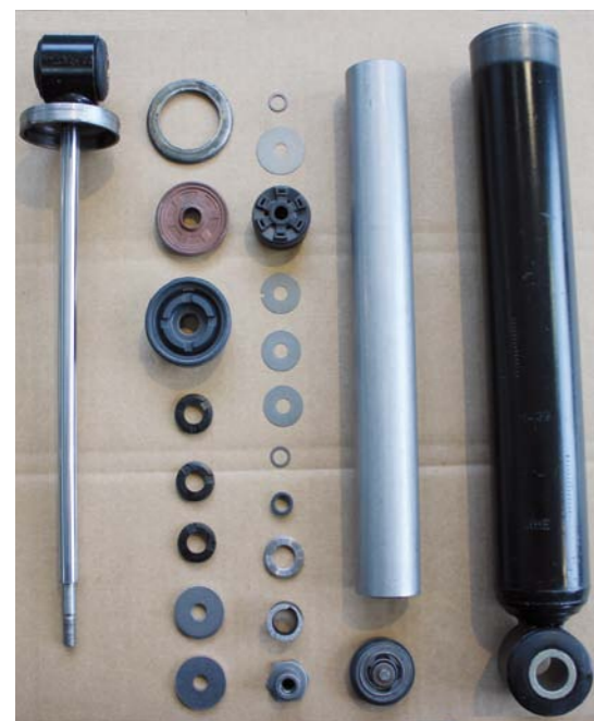
RYS. 12. PRAWIDŁOWY PRZEGLĄD AMORTYZATORA WYMAGA CAŁKOWITEGO JEGO DEMONTAŻU ORAZ DOKŁADNEGO WYCZYSZCZENIA POSZCZEGÓLNYCH CZĘŚCI DLA OCENY ICH STANU
