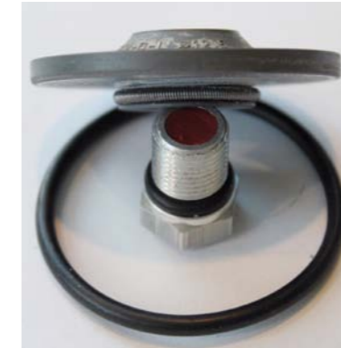
RYS. 7. USZCZELNIENIE TYPU TOP GUN FIRMY EMMETEC O SZERSZYM PIERSCIENIU DOCISKANYM DO TŁOCZYSKA OBLUDOWĄ SPRĘŻYNĄ DO ROZMIARÓW KONKRETNEGO AMORTYZATORA DAJE SIĘ DOSTOSOWAĆ PRZEZ ROZWIERCENIE GNIAZDA NA TOKARCE
