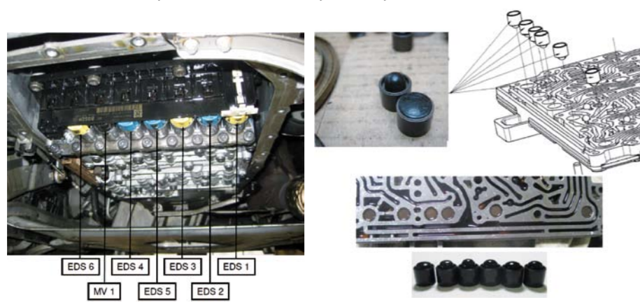
ROZMIESZCZENIE ZAWORÓW EDS W MODULE MECHATRONICZNYM SKRZYNI ZF 6 HP
