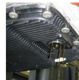
GRAWITACYJNE OPRÓŻNIENIE MISKI OLEJOWEJ SKRZYNI AUTOMATYCZNEJ
