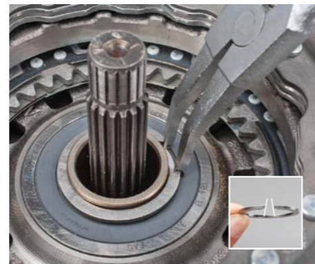
FOT. 13. OPERACJĘ KOŃCZY ZAŁOŻENIE SZCZYPCAMI KL-0192-12 PIERŚCIENIA ZABEZPIEZAJĄCEGO (ZWĘŻAJĄCĄ SIĘ SZCZELIŃĄ ZAMKA KU GÓRZE)
