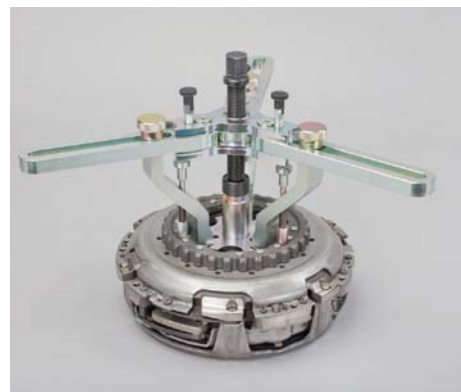
FOT. 11. NOWE SPRĘŻĘŁO PRZYGOTOWANE DO MONTAŻU
