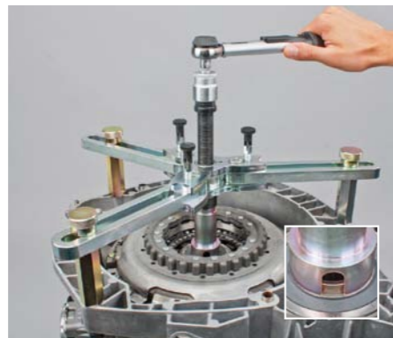
FOT. 12. WZIERNIK TULEI OPOROWEJ DO USTALANIA OSIOWEJ POZYCJI SPRĘŻŁA NA WAŁKU
