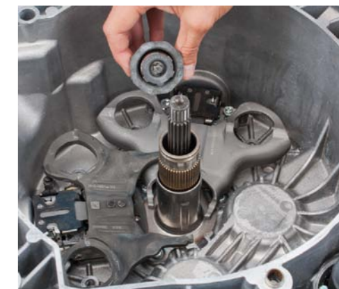
FOT. 7. KOŹNIERZE SPRĘŻYN ZWROTNYCH I OTWORY DŹWIGNI SĄ DO SIEBIE PASOWANE FABRYCZNIE
