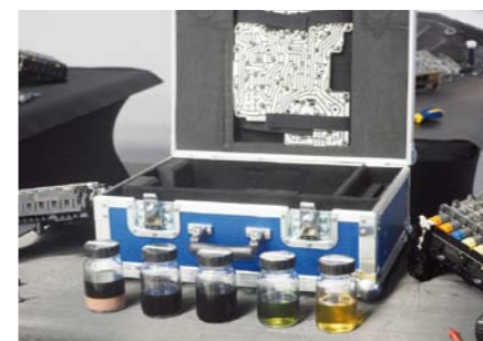
TAK WYGLĄDAJĄ PRÓBKIE OLEJU Z AUTOMATYCZNYCH SKRZYŃ BIEGÓW. W WIELU PRZYPADKACH WYMIANA JEST NIEZBĘDNA
