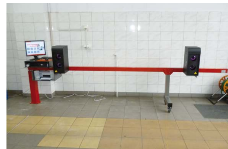
WERSJA KANAŁOWA URZĄDZENIA 3D NA SZLABANIE UMOŻLIWIJĄCA ODCHYLENIE W PRZYPADKU KONIECZNOŚCI UZYSKANIA STANOWISKA PRZELOTOWEGO
