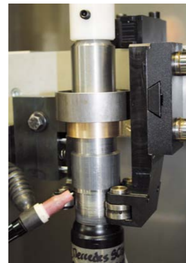
RYS. 13. MANGUSTA AUTOMATYCZNIE WYKONUJE CIĘCIE AMORTYZATORA, A NASTĘPNIE PRZYSPAWANIE DO NIEGO TULEI GWINTOWANEJ
