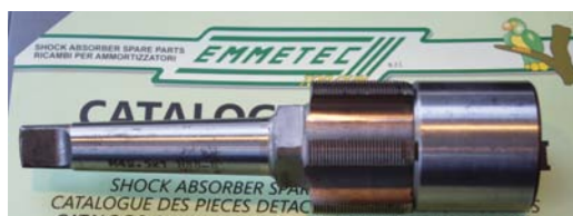
RYS. 10. GWINTOWNIK PROWADZONY PRZEZ ŚRODKOWNIK UMOŻLIWIA WYKONYWANIE GWINTÓW W KORPUSACH ZARÓWNO RĘCZNIE, JAK I NA TOKARCE
