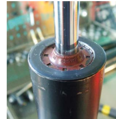
RYS. 4. ZAMKNIĘCIE POPRZECZ WYWINIĘCIE KOŁNIERZA DOMINUJE W AMORTYZATORACH DWURUROWYCH EUROPEJSKICH
