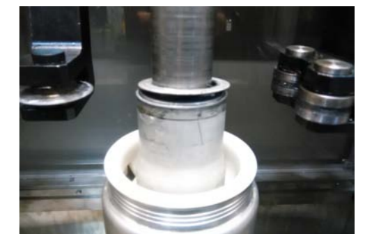
RYS. 7. ZA POMOCĄ MANGUSTY MOŻNA OTWIERAĆ AMORTYZATOR ALUMINIOWY, SKRACAJĄC JEGO DŁUGOŚĆ JEDYŃNIE O JEDEN LUB DWA MILIMETRY
