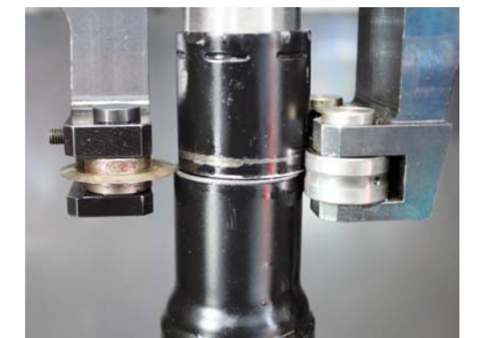
RYS. 6. SYSTEM MANGUSTA UMOŻLIWIA PROSTE, SZYBKE I PRECYZYJNE OTWARCIE PRAWIE WSZYSTKICH AMORTYZATORÓW, BĘDĄC NAJLEPSZYM I NAJBARDZIEJ OPEŁALNYM ROZWIĄZANIEM
