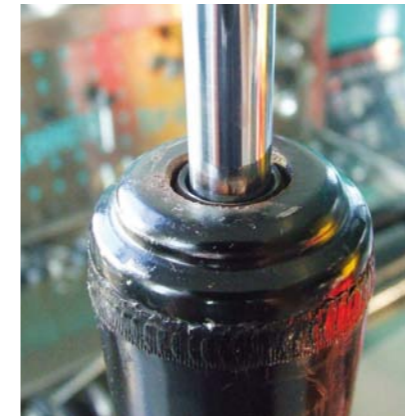
RYS. 3. ZAMKNIĘCIE METODĄ SPAWANIA JEST TYPOWE DLA AMORTYZATORÓW DWURUROWYCH POŁUDNIOWO-AMERYKAŃSKICH I AUSTRALIJSKICH
