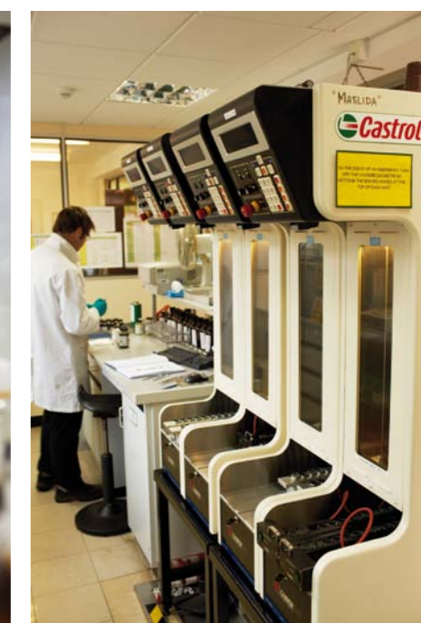
DO NAJWAŻNIEJSZYCH WŁAŚCIWOŚCI PROTOTYPOWEGO OLEJU NALEŻY JEGO LEPKOŚĆ KINEMATYCZNA. BADANA ZA POMOCĄ SPECJALNEJ APARATURY
