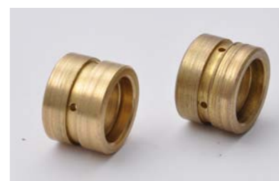
ŁOŻYSKA PORYSOWANE PRZEZ ZANIECZYSZCZONY OLEJ
