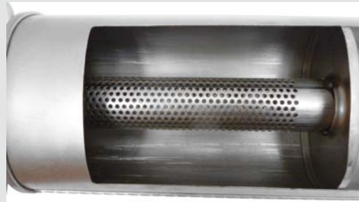
Przekrój prostego tłumika refleksyjnego. Efektywny zakres tłumienia 63-200 Hz i w mniejszym stopniu 1600-2500 Hz
