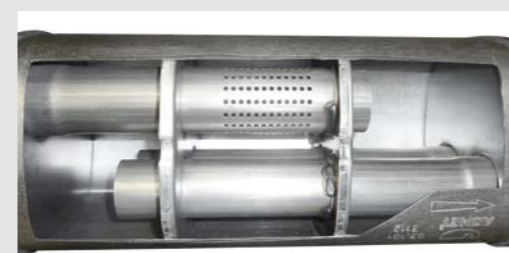
Przekrój tłumika interferencyjnego. Efektywny zakres tłumienia 63-315 Hz
