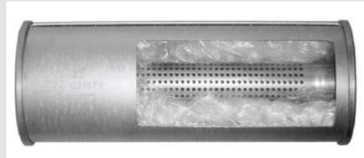
Przekrój tłumika absorpcyjnego. Efektywny zakres tłumienia 1000-4000 Hz
