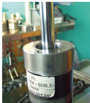
RYS. 12. ZEWNĘTRZNY PIERŚCIEŃ ZAMYKAJĄCY AMORTYZATORY SAMOCHODU PORSCHE CAYENNE
