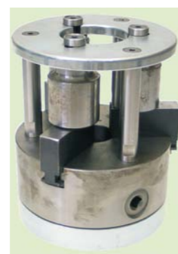
RYS. 16. SPECJALNA PRASA DO FORMOWANIA ZAGNIATANEGO ZAMKNIĘCIA AMORTYZATORA
