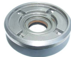
RYS. 3. PROWADNICA TŁOCZYSKA Z OSADZONĄ W OTWORZE OPASKĄ GUMOWĄ, PEŁNIĄCĄ FUNKCJĘ ZAWORU ZWROTNEGO
