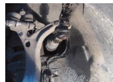
ZAMONTOWANY DRĄŻEK KIEROWNICZY, PRZYKŁAD VW
