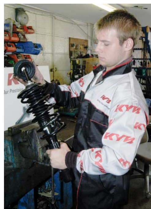
MONTAŻ ELEMENTÓW ZESPOŁU TŁUMIĄCO-RESORUJĄCEGO
