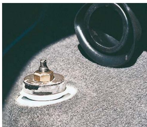
POMINIĘCIE KAPTURKA OCHRONNEGO PRZY MONTAŻU AMORTYZATORA BYWA PRZYCZYŃĄ HAŁASLIWEJ PRACY ZAWIESZENIA
