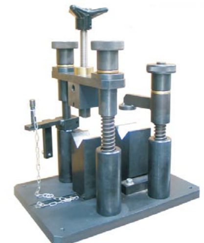
RYS. 13. REGULACJĘ CIŚNIENIA, A ZWŁASZCZA JEGO ZWIĘKSZANIE, MOŻNA WYKONYWAĆ TYLKO W AMORTYZATORZE OSADZONYM W SPECJALNYM STATYWIE
