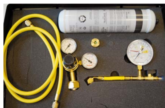
ZESTAW OPRZYRZĄDOWANIA DO CIŚNIENIOWEJ KONTROLI SZCZELNOŚCI OBIEGU CZYNNIKA CHŁODNICZEGO ZA POMOCĄ AZOTU
