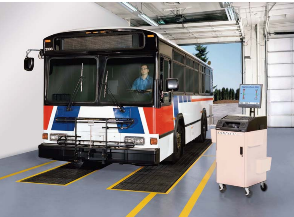
UNIwersalne płyty do badania sił hamowania mogą stanowić konkurencję dla powszechnie stosowanych stanowisk rolkowych
