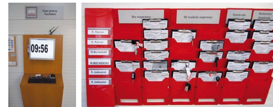
STANOWISKO LOGOWANIA SIĘ TECHNIKÓW WRAZ ZE ZBIOREM DOKUMENTACJI SERWISOWEJ ORAZ TABLICA PLANOWANIA PRACY W HALI WARSZTATOWEJ
