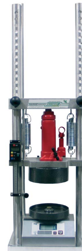
RYS. 9. STÓŁ EMMETEC 99-966 DO ELEKTRONICZNEGO BADANIA CHARAKTERYSTYK SPRĘŻYN
