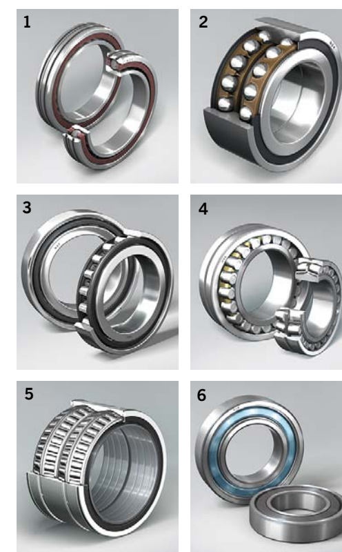
POJEDYNCZE ŁOŻYSKA KULKOWE (1) SĄ ROZWIĄZANIEM OPTYMALNYM PRZY MAŁYCH OBCIĄŻENIACH. PRZY WIĘKSZYCH KORZYSTNIEJSZA JEST KONSTRUKCJA DWURZĘDOWA (2) LUB ROLKOWA (3), A PRZY ZNACZNYCH SIŁACH OŚIOWYCH -PODWÓJNIE STOŻKOWA (4 I 5). WE WSZYSTKICH PRZYPADKACH TRWAŁOŚĆ ZALEŻY RÓWNIEŻ OD JAKOŚCI USZCZELNIENIA (6)
