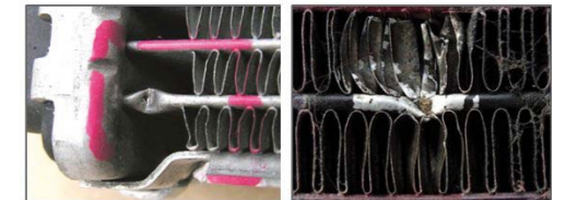
Typowe uszkodzenia mechaniczne chłdnicy powstałe podczas eksploatacji samochodu
