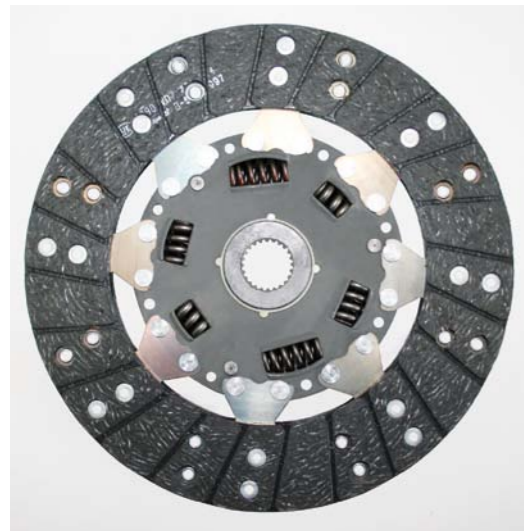
TARCZA SPRĘGŁA Z TŁUMIKAMI DRGAŃ
