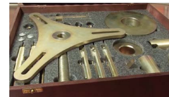
KLUCZ HETMAN FIRMY HUZAR DO NAPRAWY I WYMIANY PODWÓJNEGO SPRZĘGŁA SUCHEGO W AUTOMATYCZNEJ SKRZYNI DSG
