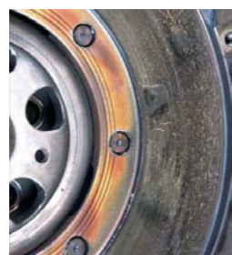
CAŁKOWITE ZNISZCZENIE DKZ NA SKUTEK ZNAZNEGO PRZEGRZANIA. Z PRAWY: USZKODZONA PRZEGRZANIEM ZEWNĘTRZNA POWIERZCHNIA CIERNA
