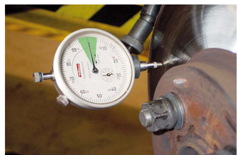
POMIAR BICIA STAREJ TARCZY NALEŻY PRZEPROWADZIĆ PRZED JEJ WYMONTOWANIEM. BY DOKŁADNIE USTALIĆ PRZYCZYNY WYSTĘPUJĄCYCH ODCHYLEK
