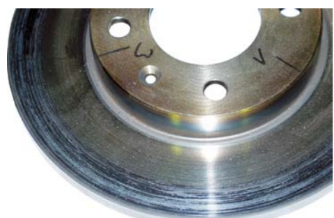
PRZY NIEZNACZNYCH UBYTKACH POWIERZCHNI I ŚLADACH JEJ PRZEGRZANIA MOŻNA TARCZĘ DOPUŚCIĆ DO DALSZEGO UŻYTKU, ALE PRZEWAŻNIE NIE WARTO
