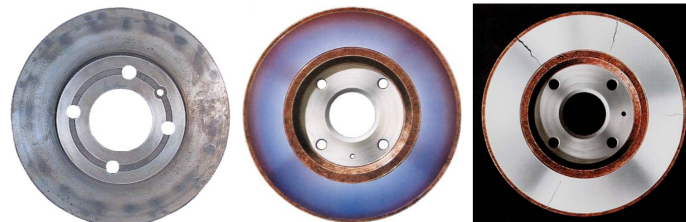
TARCZA BEZWZGLĘDNIE WYMAGA WYMIANY. JEŚLI: USZKODZENIA JEJ POWIERZCHNI NIE ROZKŁADAJĄ SIĘ RÓWNOMIERNIE (Z LEWEJ), MATERIAŁ ULEGŁ PRZEBARWIENIU ŚWIADCZĄCEMU O TERMICZNYCH ZMIANACH JEGO WEWNĘTRZNEJ STRUKTURY (ZDJĘCIE ŚRODKOWE), POJAWIŁY SIĘ JAKIEKOLWIEK PĘKNIĘCIA PŁASZCZYZN CIERNYCH (Z PRAWIEJ)
