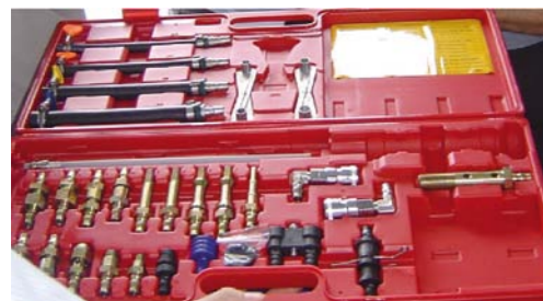
JEDEN Z ZESTAWÓW SZYBKOZŁĄCZY STANOWIĄCYCH WYPOSAŻENIE URZĄDZENIA SERWISOWEGO LIQUI MOLY
