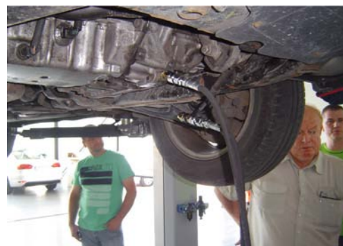
DOPROWADZENIE PRZYŁĄCZY URZĄDZENIA DO GWINTOWANYCH OTWORÓW W OBUDOWIE AUTOMATYCZNEJ SKRZYNI BIEGÓW PODCZAS DYNAMICZNEJ WYMIANY PŁYNU
