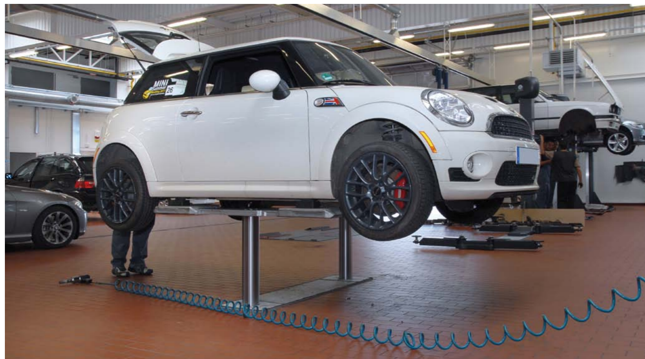
CO 2 LATA KONIECZNA JEST WYMIANA OLEJU HYDRAULICZNEGO W PODNOŚNIKACH, A WĘŻY HYDRAULICZNYCH – CO 5 LAT
