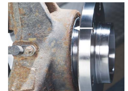
PRZYCYNĄ NADMIERNEGO OPORU PRZY WYKONYWANIU POŁĄCZENIA WCISKOWEGO JEST ZWYKLE KOROZJA GŁADZI W ODKUWCE ZWRÓTNICY LUB ZADZIORY SPOWODOWANE WCZEŚNIEJSZYMI BŁĘDAMI MONTAŻOWYMI
