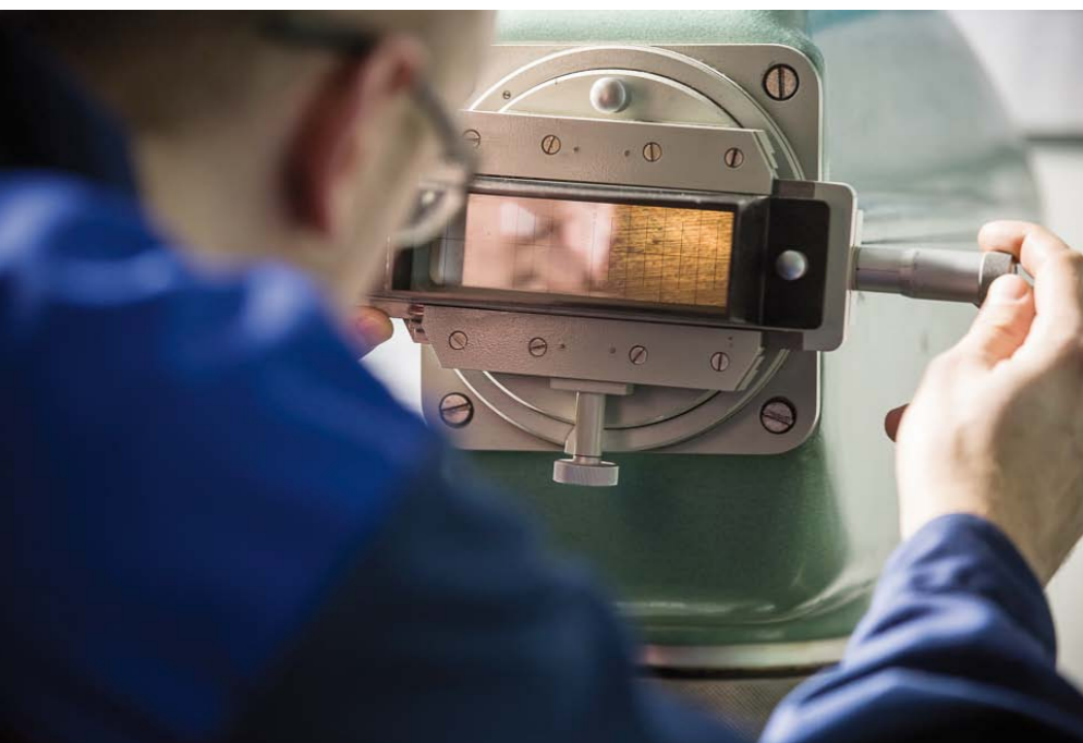
MIKROSKOPOWE BADANIE POWIERZCHNI PRÓBKİ W TRAKCIE POMIARU TWARDOŚCI METODĄ VICKERSA
