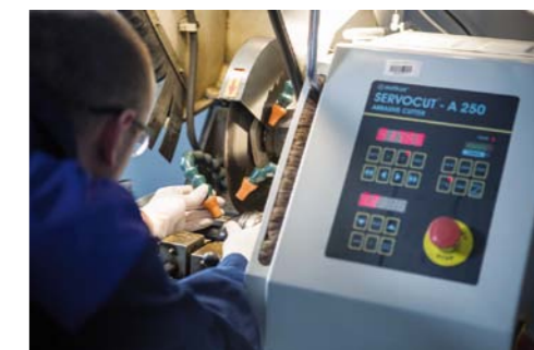
KOMPUTEROWA PRZECINARKA SERVO-CUT-A250 DO PRECYZYJNEGO WYCINANIA PRÓBEK MATERIAŁÓW STALOWYCH
