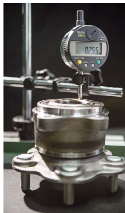
STANOWISKO DO KONTROLI WIELKOŚCI ODCHYLEK WYMIAROWYCH ZA POMOCĄ ELEKTRONICZNEGO CZUJNIKA POMIAROWEGO
