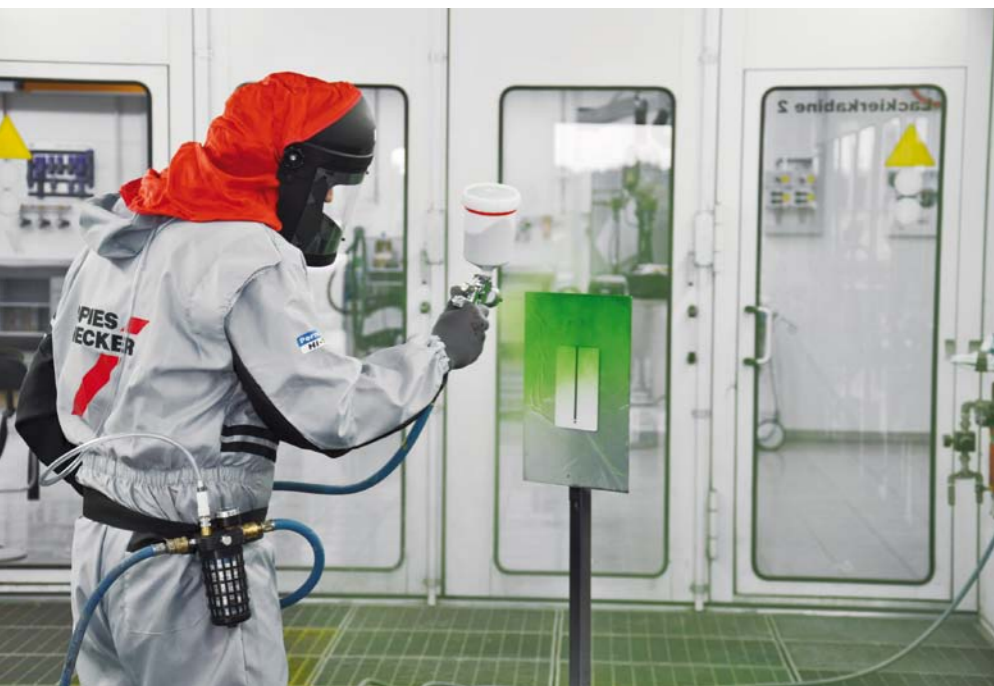
WYKONANIE PRÓBNYCH NATRYSKÓW POZWALA UNIKNĄĆ BŁĘDÓW W DOBORZE KOLORU I NIEWŁAŚCIWEJ APLIKACJI
