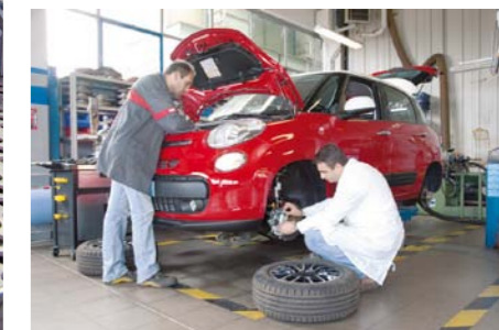
ZAKŁAD BADAWCZO-WDROŻENIOWY PRZY FABRYCE: PRZYGOTOWANIE SAMOCHODU DOŚWIADCZALNEGO DO DROGOWEGO TESTU KŁOCKÓW HAMULCOWYCH
