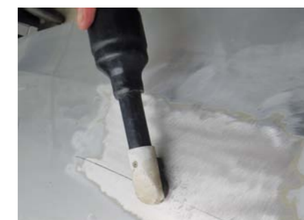
PODGRZEWACZEM INDUKCYJNYM MOŻNA OBKURCZAĆ ROZLEGŁE WGNIECENIA LUB GRZAĆ JE PRZED PROSTOWANIEM MECHANICZNYM
