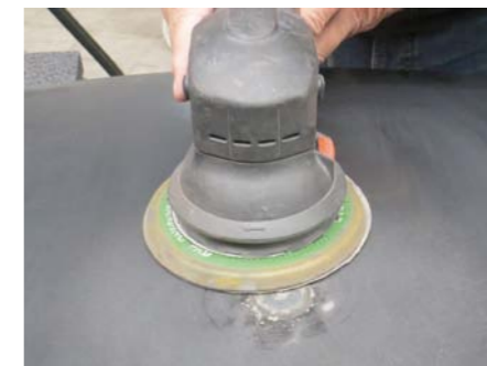
KOŃCOWĄ OBRÓBKĘ NAPRAWIANEJ STREFY WYKONUJE SIĘ SZLIFIERKĄ USUWAJĄCĄ DROBNE WZERY I RYSY
