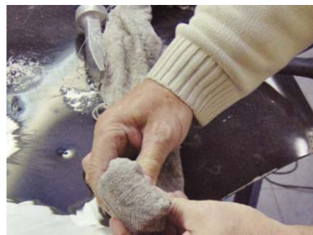
KLEPADŁO STALOWE ZASTOSOWANE DO PROSTOWANIA BLACHY ALUMINIOWEJ POWINNO MIEĆ CZĘŚĆ ROBOCZĄ OWINIĘTĄ TKANINĄ
