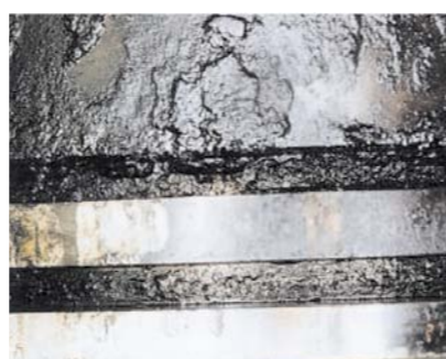
KOLEJNE FAZY UTRATY SZCZELNOŚCI POŁĄCZENIA TŁOKA Z CYLINDREM. POWODOWANEJ NAWARSTWIANIEM SIĘ OSADÓW I BLOKOWANIEM PRZEZ NIE PIERŚCIENI TŁOKOWYCH W ROWKACH
