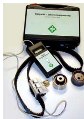
PRZYRZĄD DO KONTROLI NAPIĘCIA PASKA ROZRZĄDU
