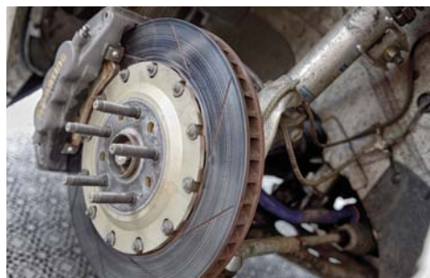
WYŚCIGOWE, SZTYWNIJSZE ZAWIESZENIE ZMNIJSZYŁO PRZEŚWIT SAMOCHODU, ZWIĘKSZAJĄC RÓWNOCZEŚNIE ROZSTAW KOŁ
