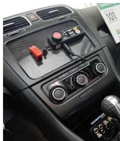
OKRĄGŁY, CZERWONY PRZYCIŚK SYSTEMU PUSH-TO-PASS MOŻE ZWIĘKSZYĆ CHWILOWO MOC SILNIKA DO 310 KM
